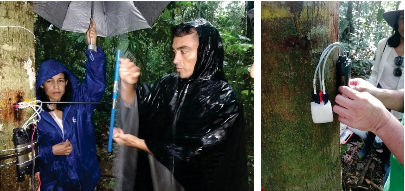
Instalación del sensor de flujo masico
