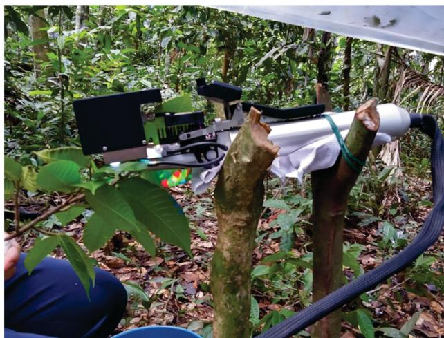
**Figura** - Instalación del CIRAS 3 en el área de trabajo (a) y pinza del CIRAS 3 durante la toma de datos (b)
